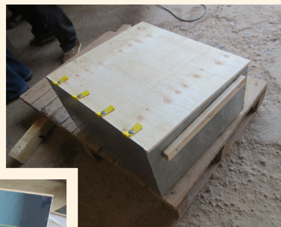
Kuva peltirakenteisesta uunista päällikansi suljettuna.
